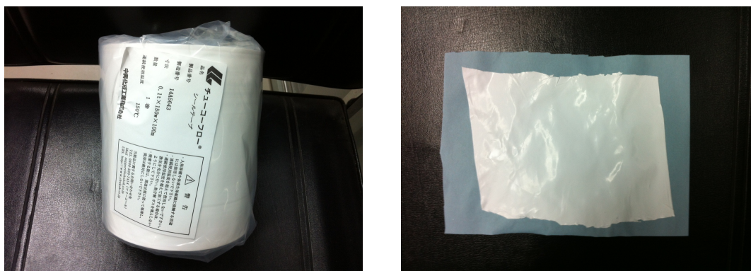
図 5.12: シールテープ。左図が 150^W \times 0.17^T [mm] のシールテープ 100 m 巻き。右図がシールテープを切り取ったもの。
