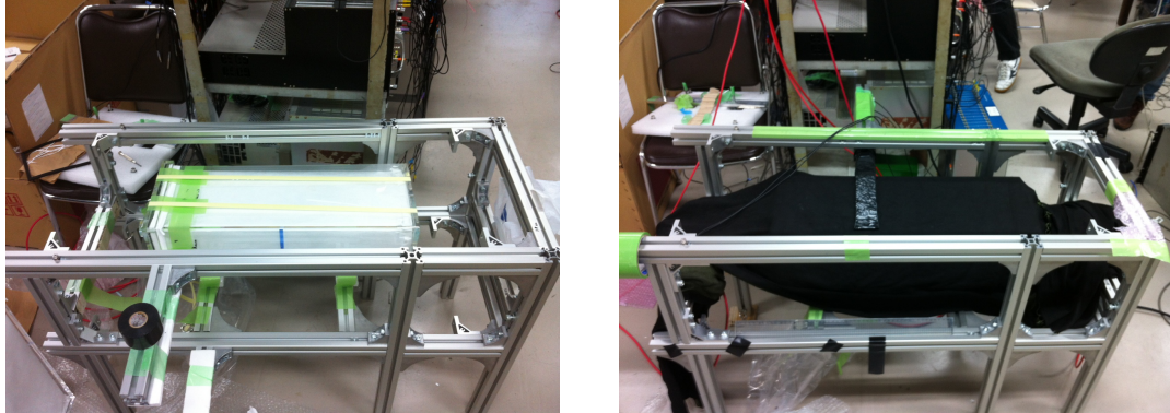
図 5.1: 宇宙線実験のセットアップの外観図。左図のように水チェレンコフ検出器を水平に設置した。右図は遮光した後、その上下にトリガーカウンターを設置した様子。
