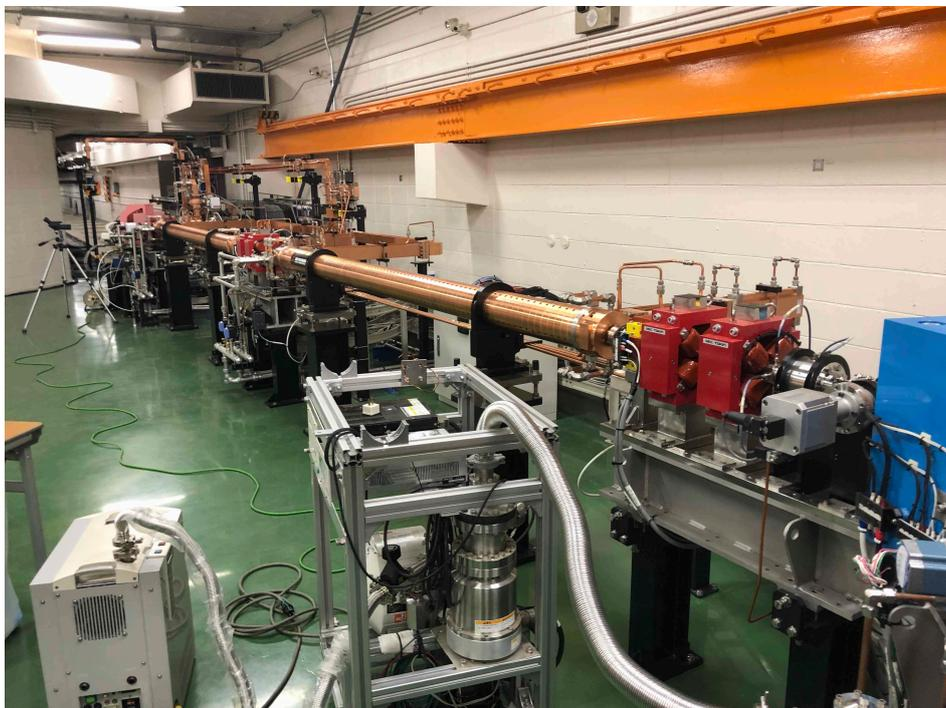
図 3.3: 下流から見た電子線形加速器
