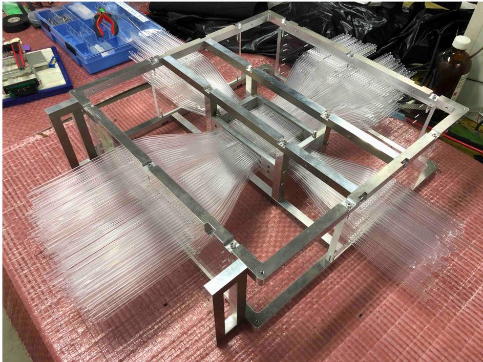
図 2.21: AFT 試作機にファイバーを通した状態の写真
