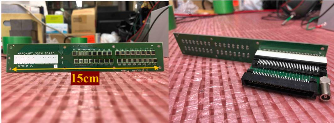
図 2.18: AFT 試作機に使用した MPPC 基板の写真。右図は MPPC 基板に中継基板が取り付けられている面を示す。
