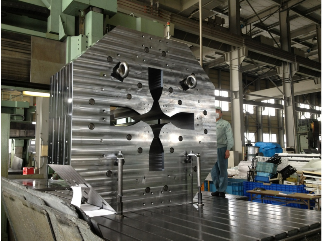
図 3.6: 制作された Q1 電磁石の鉄芯の写真。縦・横各 2.4 m、奥行き 0.88 m という大きさで、上下の 2 パーツに分けられるような構造になっている。
