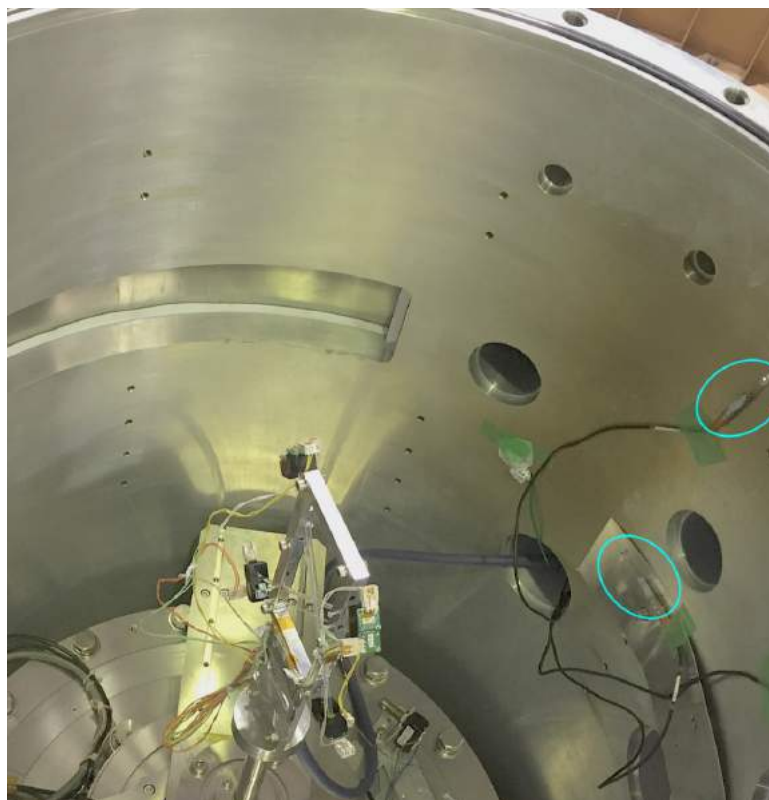
図 3.6: 散乱槽内部の様子。青い円で示すように、散乱槽内壁に青色 LED を 2 つ設置した。
