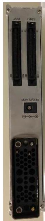
図 2.13: EASIROC MODULE の背面部分。64ch の LVDS 出力があるが, 本開発では使用しない。
