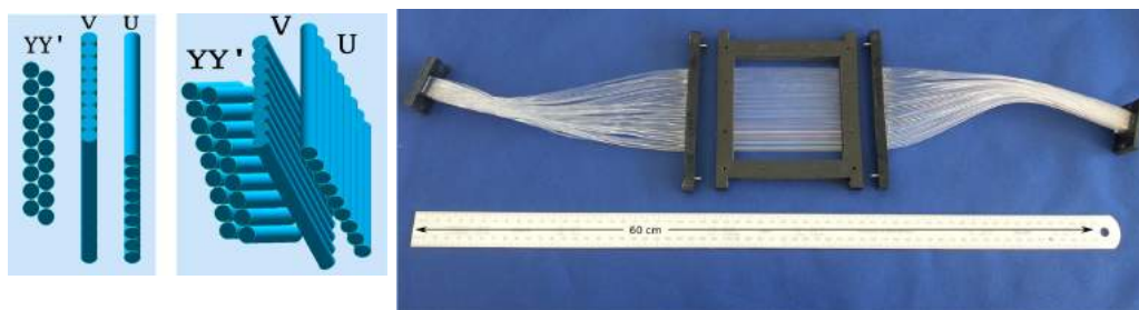
図 2.1: PSI の MUSE で使用されている、ファイバーを用いた粒子識別検出器 (TASFID)。
