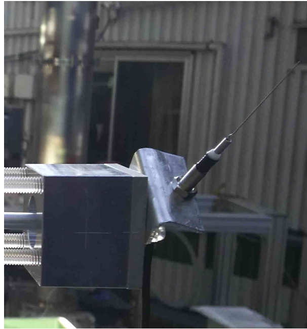
図 2.12: ホールプローブの先端が固定されているアルミ製の治具とリミットスイッチ。先端のワイヤー部分が押し込まれることでスイッチが切りかわり、導線が電氣的に断線するという仕組みになっている。
