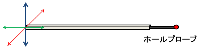
図 2.6: 駆動装置とホールプローブによる磁場測定概念図。ホールプローブを取り付けた棒を駆動装置で 3 次元的に移動し、ホールプローブの先端についた 3 つのホール素子で磁場の 3 成分を測定する。
