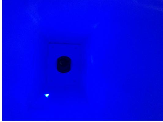
図 3.6: エネルギー較正に用いた青色 LED が水チェレンコフ検出器の水槽内で発光する様子。
