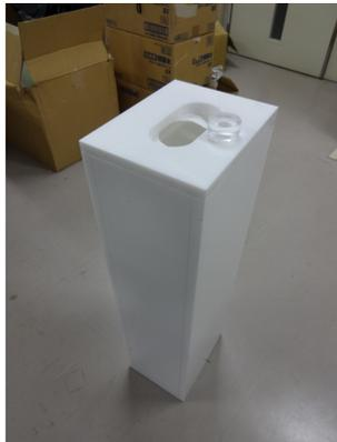
図 2.12: 水チェレンコフ検出器全体の外観。上面の栓は給水口である。ここから水の給水及び排水を行うことができる。
