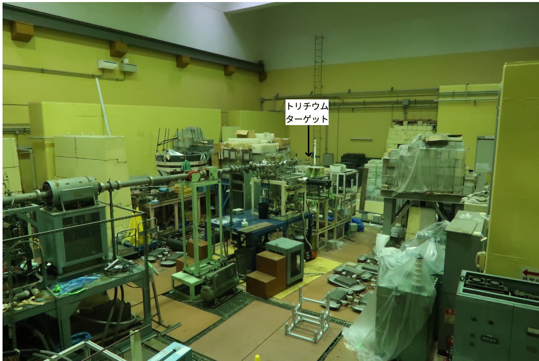
図 6.3: 大実験室およびパルスビームライン. 写真中央にパルスビームラインのトリチウムターゲットが設置されている. 写真左手前から加速されたデュテリウムが照射される.
