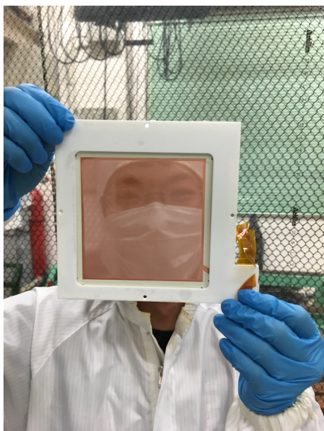
図 2.21 MAIKo ですでに使用されている GEM。GEM 表面には数多くの穴が空いており、反対側が透けて見える。写真の人物は著者本人である。
