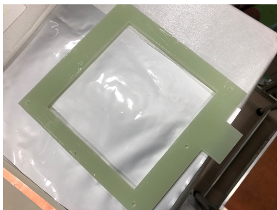
図 2.23 GEM を貼り付けるために G10 のフレームにアラルダイトを塗布した。
