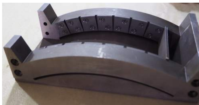
図 3.8 Gion 架台のスペーサー
