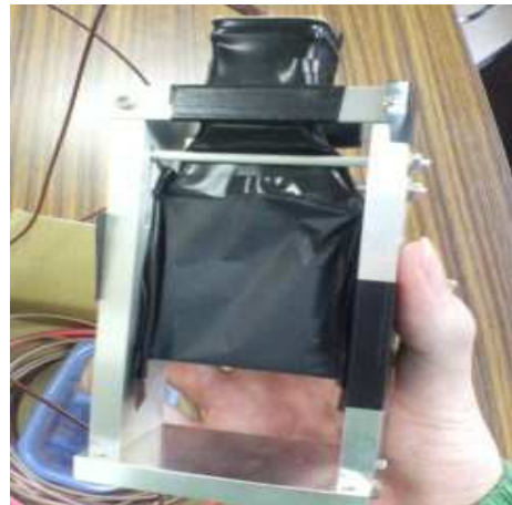
図 6: 実験で用いた光電子増倍管 (左) とシンチレーター (右)
