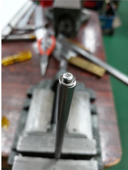
図 5.4 ステンレスロッドのネジ穴部分
