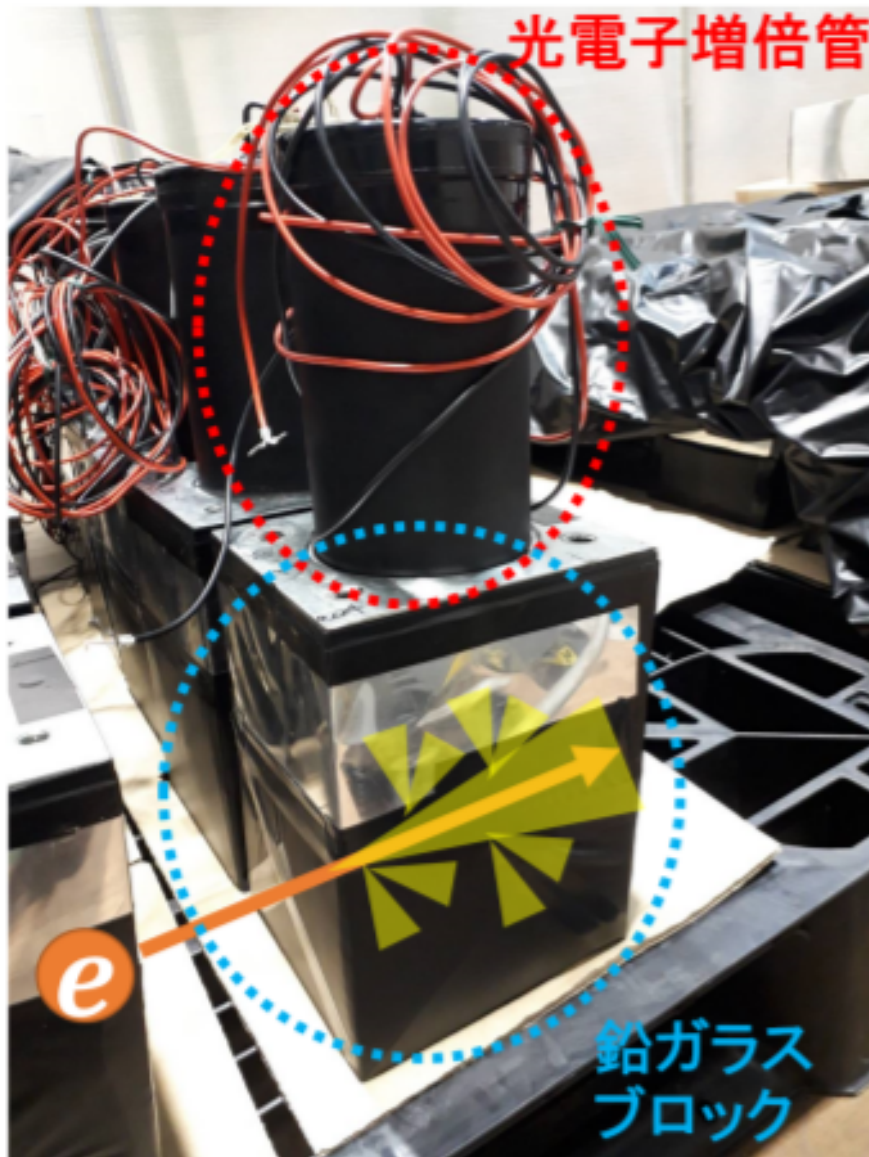
図 2.13: LG の実物写真および簡単な検出原理 [7]
