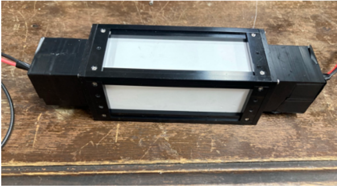
図 4.6 PMT を取り付けた GAGG(Ce) シンチレーターのセットアップ。結晶を反射材の Gore-Tex で覆い、デルリン製のフレーム保持している。
