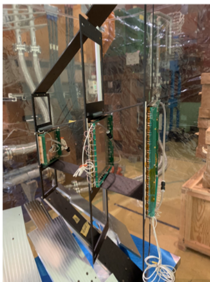
図 2.12: フレームに取り付けられた GTR[20]. 中段左から 100GTR, 200GTR, 300GTR が取り付けられている.
