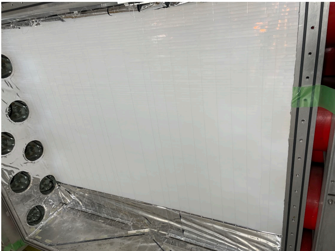
図 20: AC 内部の写真。約 1000 枚のエアロゲルが積層されている。
