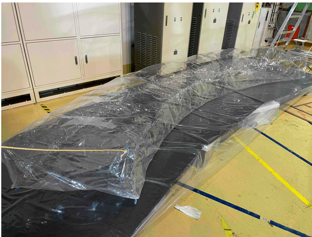
図 16: S-2S の D 電磁石内部の粒子軌道に設置する ^4\text{He} を封入する袋 (ヘリウムバッグ) の写真。同様のヘリウムバッグを Q1、Q2 内部にも設置した。粒子通過面は 16\mu\text{m} 厚のマイラー製フィルムが用いられている。
