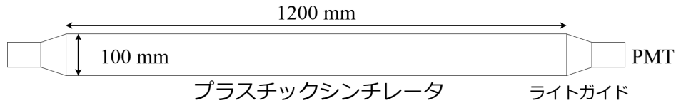
図 2.5.1 プラスチックシンチレーション検出器の平面図。図奥行き方向の厚さは上流からそれぞれ 1 mm、3 mm、10 mm 厚。
