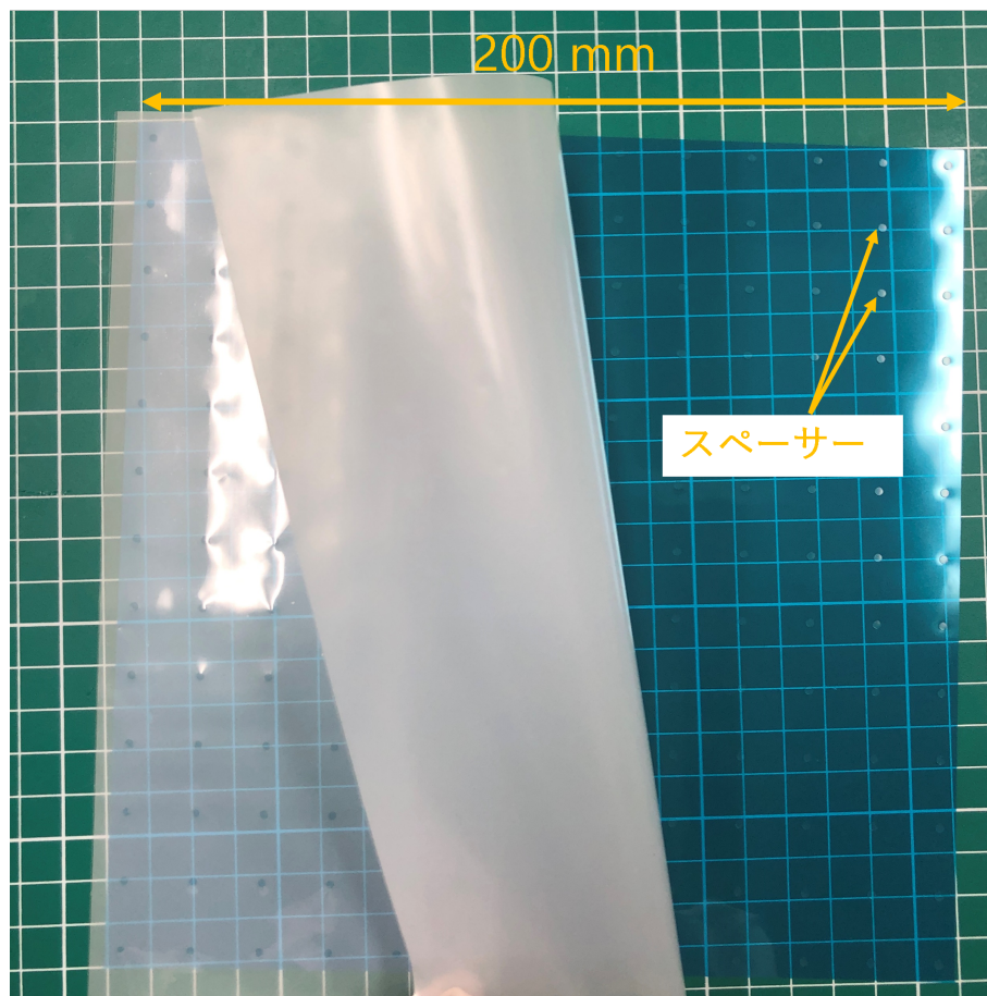
図 4.7: ポリエステルフィルムスペーサーの外観。青い台紙に直径 2 mm の円形スペーサーが張り付いている。まず白い保護フィルムを剥がして、ガラスにスペーサーを押し付けた後青い台紙も剥がすと、ガラスにスペーサーがくっついて残る。
