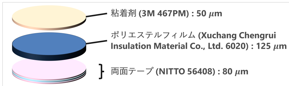
図 4.6: ポリエステルフィルムスペーサーの構造。市販のフィルムやテープを組み合わせている。
