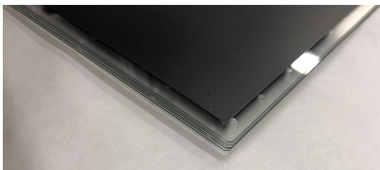
図 4.15: 5 gap 分積み上げたガラス。ガスギャップ内にスペーサーが見える。
