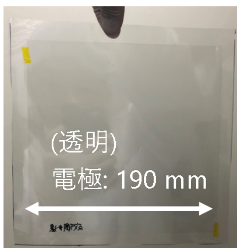
(d) セプルジーダが塗布されたフィルム。 ガスタイト用の大きなフィルムの中央にセプルジーダが塗布された小さいフィルムを固定している。
