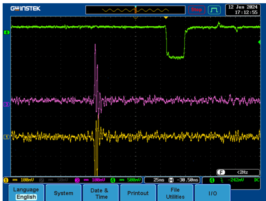
図 5.6: 宇宙線試験で観察できた信号。CS-6301(ガラス塗布) に 12 kV を印加した。ch 1(黄) は anode、ch 2(紫) は cathode の信号で、同一位置にあるストリップのため、逆向きで同じタイミングの信号が出ている。
