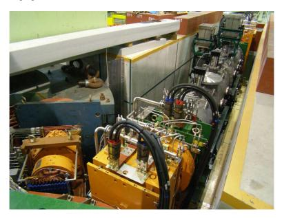
図 2.4: 第二段静電セパレータ。写真手前がビーム上流側であり、そこから黄色の収束電磁石 Q7、八極極電磁石 O2、六極極電磁石 S3、緑色の静電セパレータ用偏向電磁石 CM3 とあり、その奥に見えている銀色の装置が静電セパレータである。
