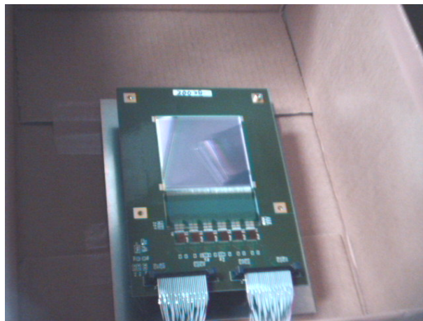
図 3.12: 発熱の study。SSD はセンサー四隅にあるねじ穴部以外は浮いている。
