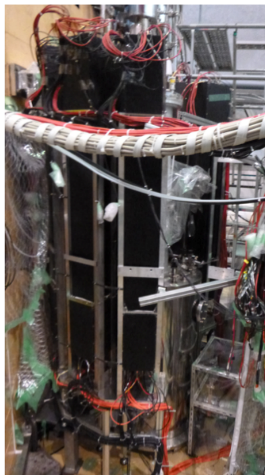
図 3.2: 実際にインストールされた飛程検出器。周りの検出器の架台と固定具で連結しており、安定化を図っている。
