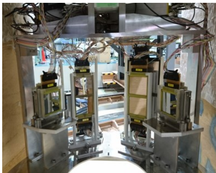
図 2.10 実際に使用した Si 検出器アレイ (下流から見た図)
