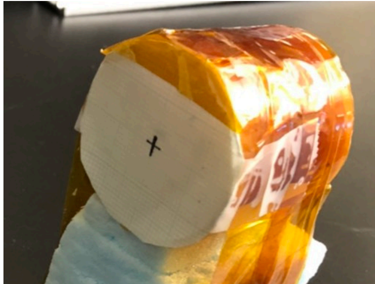
図 4.5. ポリエチレン標的。直径 4 cm、高さ 4 cm の円筒形である。十字の印にビーム中心を合わせる。
