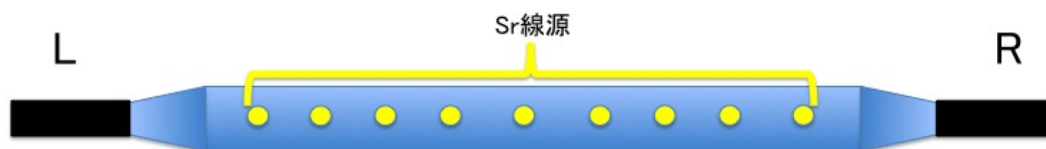
図 3.14: Sr 線源による減衰長、物質中での光速測定のセットアップ。シンチレータの先端 10cm の位置から 10cm 置きに計 9 カ所に設置し、そのときの ADC および TDC を測定した。
