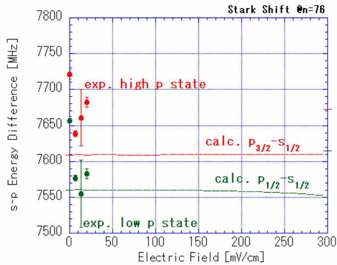
図 5.2: 本実験で得られた主量子数 n が 76 における s - p 間のシュタルクシフトとシュタルク構造計算の結果
