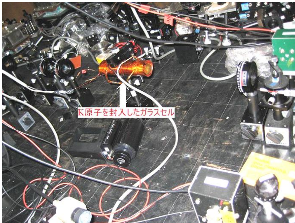
図 3.7: 吸収線測定装置周辺の写真
