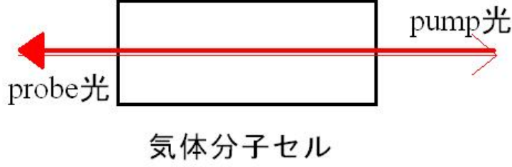
図 2.9: セルを通過するポンプ光とプローブ光
