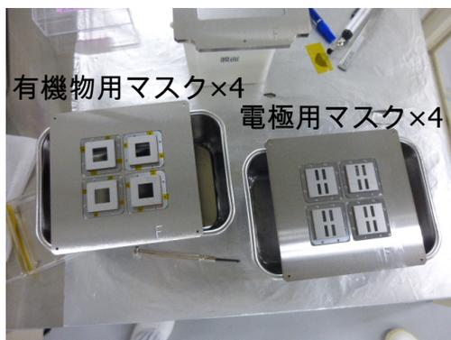
図 2.20 蒸着用のマスク。これを基板にかぶせた状態で蒸着を行う。
