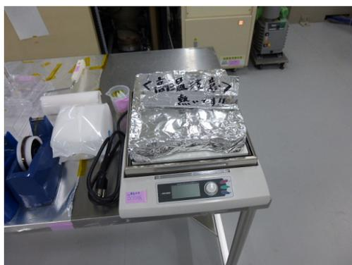
図 2.24 加熱による本乾燥の様子。
