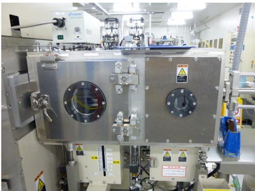
図 2.18 蒸着装置。基板を内部にセットし、蒸着作業を行う。
