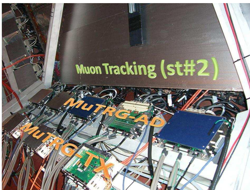
図 1.3: 2007 年夏の動作試験において、MuTRG-AD, TX ボードを MuTr に設置した時の写真
