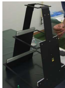
図 2.6 GTR の写真 [8]: (左) 三段の GTR(100 mm × 100 mm、200 mm × 200 mm、300 mm × 300 mm)、(右) 骨組み
