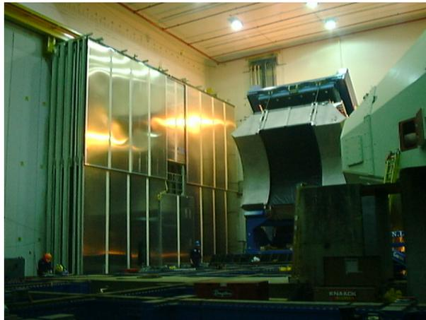
図 2.6: 壁際に設置されているのが MuID である。実際の測定時には MuID の手前に Muon Arm magnet が入るのでこのように全体を見ることはできなくなる。
