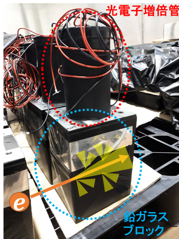
図 3.7: E16 実験で使用する鉛ガラスカロリメータ 1 ブロックの写真。鉛ガラスは遮光のためシートで覆われている。
