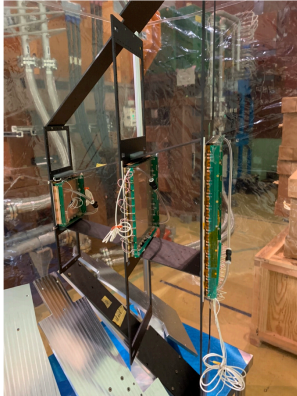
図 2.9: GTR1 モジュールの写真。左より 1 層目、2 層目、3 層目。
