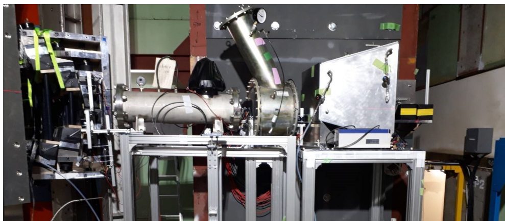
図 4.3: 性能評価用セットアップをビーム軸方向から撮影した写真。写真左が上流、右が下流であり、検出器は左から GC1、GC2、HBD、LG の順に設置されている。
