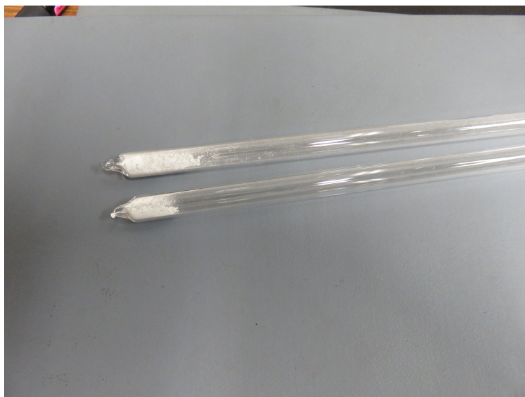
図 7.1: 石英管に封入された ^{nat}\text{MoO}_3 粉末標的
