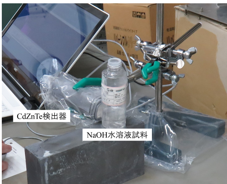
図 3.6: CdZnTe 検出器での測定の様子
