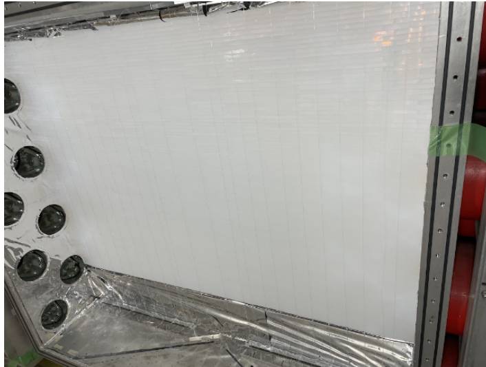
図 2.21: AC1 の内部写真. 約 1000 枚のエアロゲルが輻射体として利用されている. [28] より引用.
