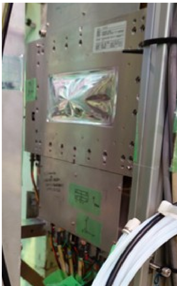
図 2.16: 下流側から見た BC3. 中心付近にあるものがマイラー面であり, ここが有感領域となる.
