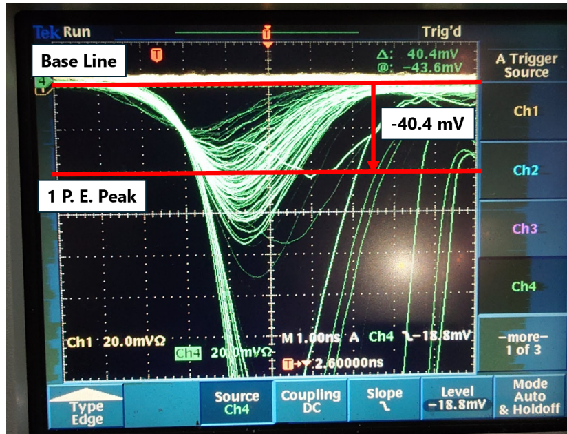
図 4.7: ^{90}\text{Sr} 使用時のアクリルチェレンコフ検出器の信号. 写真は Polished w/ WSL -x 側の信号.
