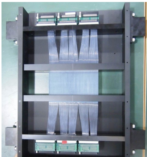
図 2.14: BFT. 垂直方向にファイバーが張られており, 水平方向の位置を検出する. 松本氏の修士論文 [27] より引用.
