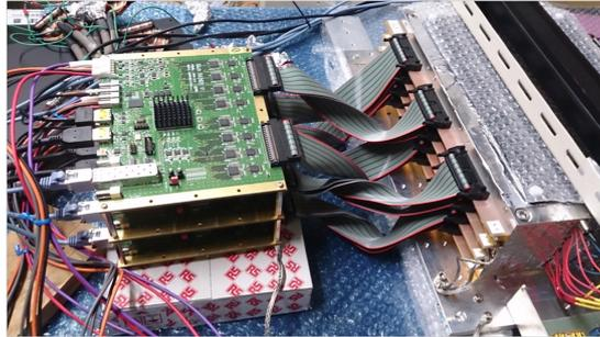
図 4.3 MWDC と 64ch RAINER の接続
