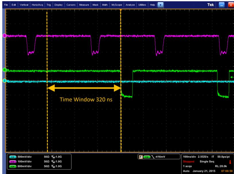
図 3.7 テストパルス用クロック。テストパルス (赤) がトリガ (緑) からの 320 ns の Time Window 内で 1 ヒットないし 2 ヒットする状況となっている。
