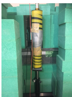
図 4.5: 気体 ^3\text{He} を封入した比例計数管を標の後方に設置した際の模様.
