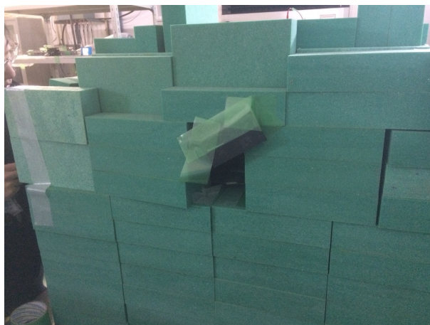
図 4.12: フラックスの入り口を邪魔するボロンゴム. 写真手前側から中性子フラックスが入射し, 穴の中にある尿素標的によって散乱が起る.
