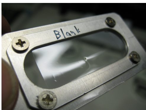
図 7.5: 常温でビームを照射した場合のポリスチレン標的。
