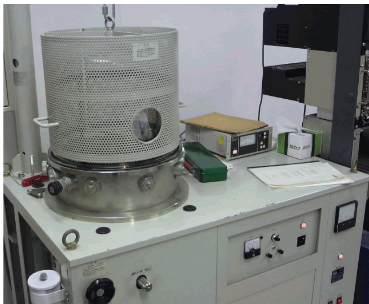
図 7.4: ポリスチレンフィルムにAlを蒸着した際に利用した装置。
