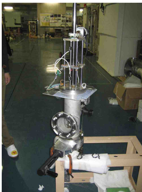
図 7.1: 標的の冷却装置。中央の円筒部分に液体窒素を流し込み、装置内部に取り付けられた標的を冷却することができる。
