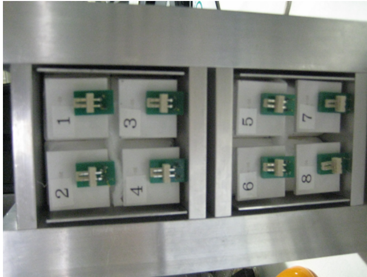
図 6.3: 図 6.2 を取り外して裏側から見た様子。8つの CsI 検出器が取り付けられている。
