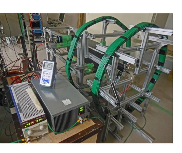
5 G環境下でWCの 宇宙線テスト: bucking coil ON/OFF
